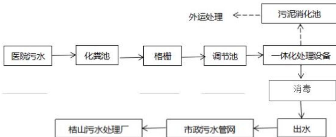
图 3-1 废水处理流程示意图
